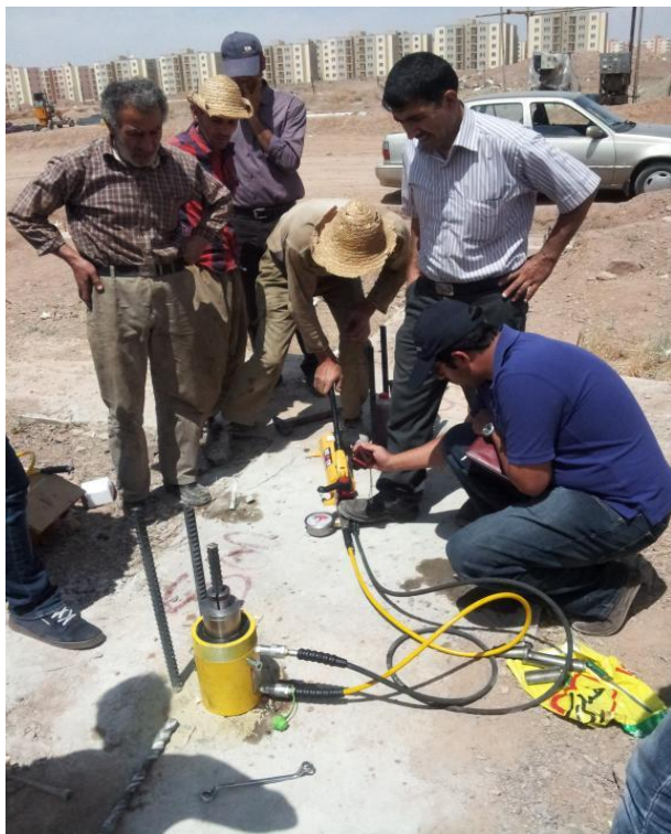
آزمایش کشش میلگرد کاشته شده در بتن
